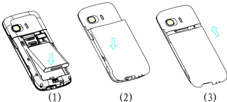
**警告：**拆卸电池之前一定要将手机关机并移去外部电源。绝对禁止在开机的情况下直接取出电池，否则可能损坏 SIM 卡和手机。
