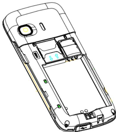
当您需要取出 SIM 卡时，请先关机，移去其他外部电源和电池，再取出 SIM 卡。
