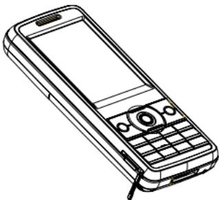
2. 将存储卡金属面朝下推入卡槽
