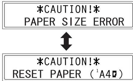
检查出现错误消息的纸盒及此纸盒中的纸张大小，然后根据下述相应的步骤装入正确的纸张。
