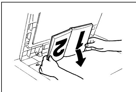
2 将原稿面朝下放置在原稿玻璃板上。
