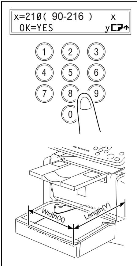
**5** 使用数字键盘，输入已装入纸张的宽度（X）。
