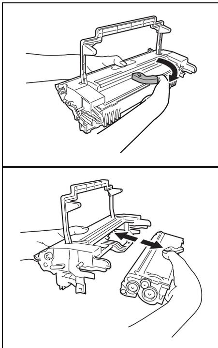
**3** 按照图中箭头所示方向移动锁定杆以解除锁定。
