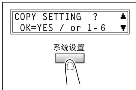
1 按 [ 系统设置 ] 键四次。将出现“COPY SETTING (复印设置)”。
