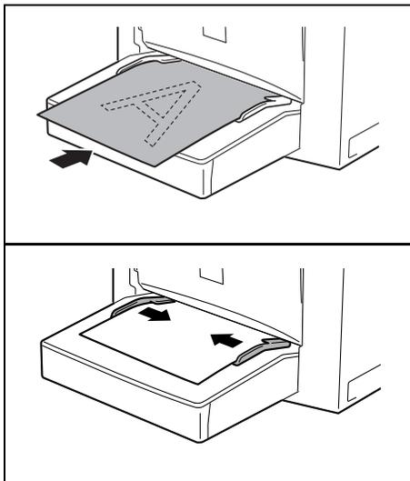
**1** 将所要打印面纸张朝上装入到手动进纸槽中。
