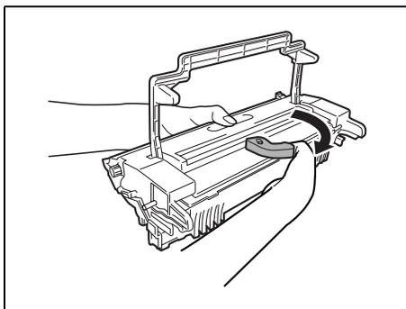
3 按照图中箭头所示方向移动锁定杆以解除锁定。
