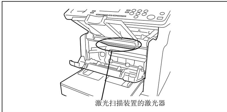
上图所示位置有一个激光器，任何情况下，非专业维修人员都不要拆开检查。机器外壳可以使您避免激光照射的伤害。
