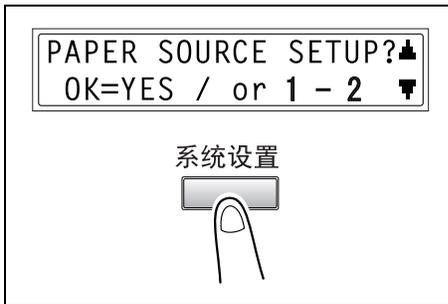
1 按 [系统设置] 键两次。将出现“PAPER SOURCE SETUP（纸张来源设置）”。
