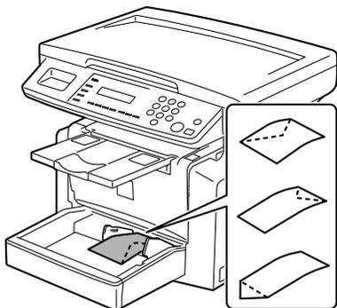
● 当装入信封时，应如图所示，将信封封口盖面朝下装入。
