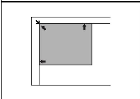
**3** 调整原稿玻璃板上原稿的位置，使原稿的角与原稿标尺左上角的箭头对齐。
