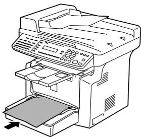
**3** 当显示屏上显示出“LOAD PAPER（装纸）”的消息时，请将纸张装入到手动进纸槽中。
