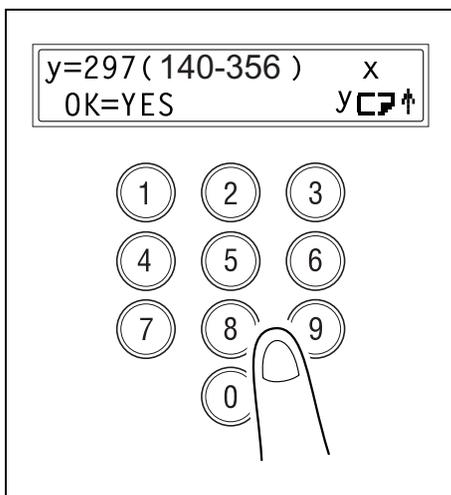
**7** 使用数字键盘，输入已装入纸张的长度（Y）。
