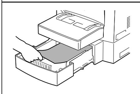
**3** 使纸张的前面（当拆开纸张包装时，面朝上的一面）朝上装入到纸匣中。
