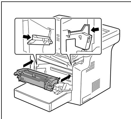
**8** 将硒鼓单元上的凸块与本设备中的导轨对齐，然后将硒鼓单元安装到设备中。
