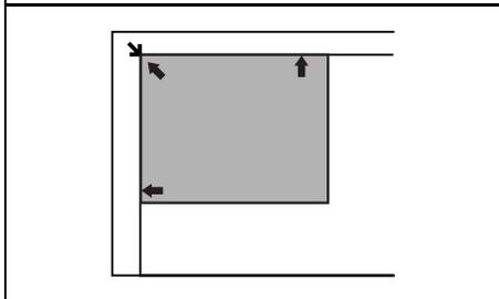
3 调整原稿玻璃板上原稿的位置，使原稿的角与原稿标尺左上角的箭头对齐。
