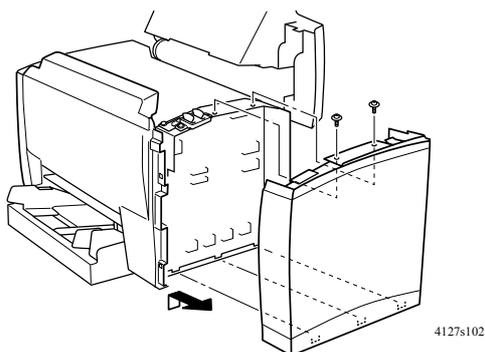
**(6) 拆下控制器板（PWB-P）**
