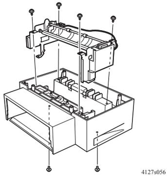
(19) 拆下连接板 (PWB-A)
