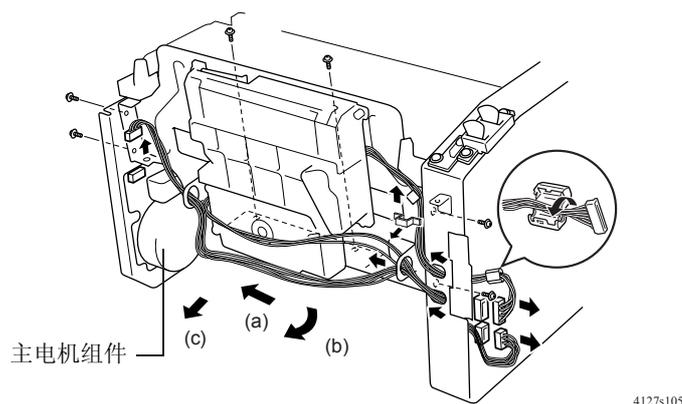
(11) 拆下纸张用尽传感器 (PE1)
