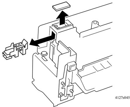
2. 拆下加热器灯固定盖（一个螺钉和一个弹簧）。
