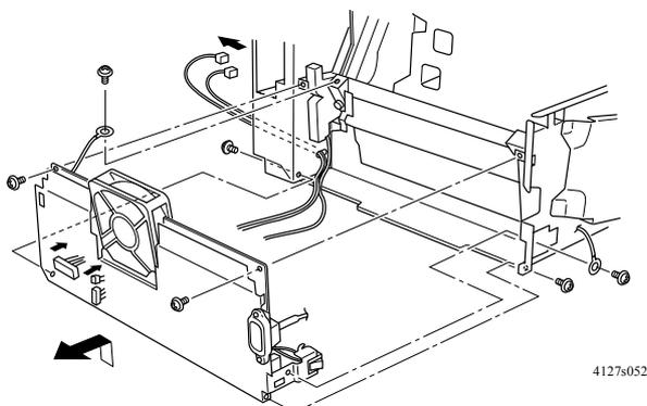
5. 拆下电源（四个螺钉）。
