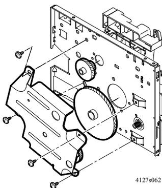
4. 拆下左侧板（四个螺钉和一个接头）。
