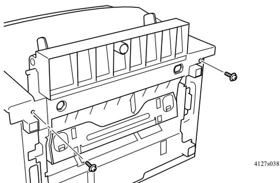
3. 将打印机正常放置，然后拆下前盖（四个位置处的翼片）。
