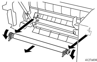
2. 从图像转印辊的两端取下轴衬和齿轮，然后将它们装配到新的图像转印辊上。
