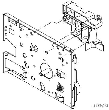
6. 拆下主电机组件（四个螺钉）。
