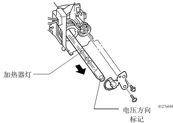
9. 从热辊上拆下驱动齿轮。
