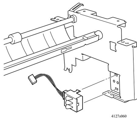
(21) 拆下辅助纸盒吸纸电磁铁 (SL21)
