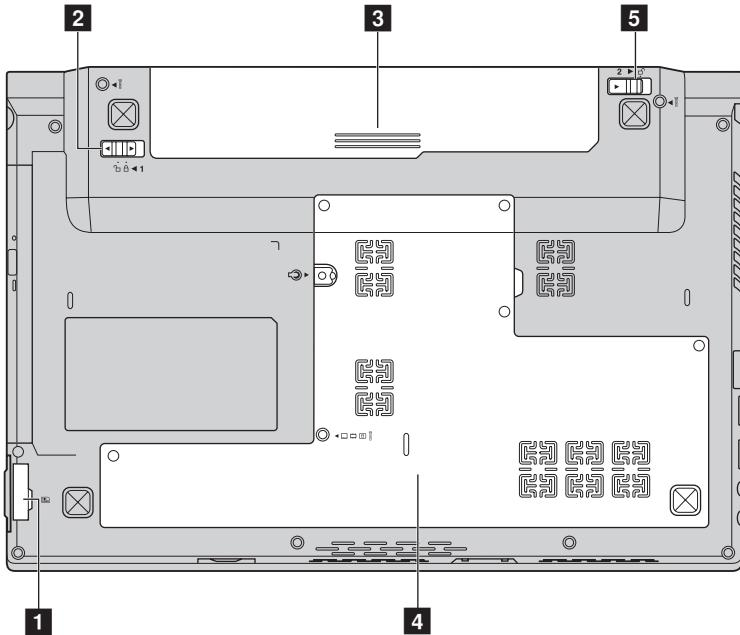
**1 SIM 卡插槽 (仅限特定型号)** 插入 SIM 卡 (未提供) 以使用移动宽带。
