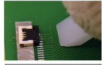
(1) 治具をスライダに当てる。 Apply the jig to the actuator.
