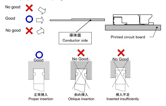
(3) スライダをロックさせて下さい。挿入した FPC が斜めになっていないか確認した上、スライダを回転軸 方向に軽く荷重を加えつつ押し下げ、ロックさせてください。
