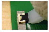
(2) 治具とスライダのセンターを 合わせる。 Align the center of the jig to the center of the actuator.
