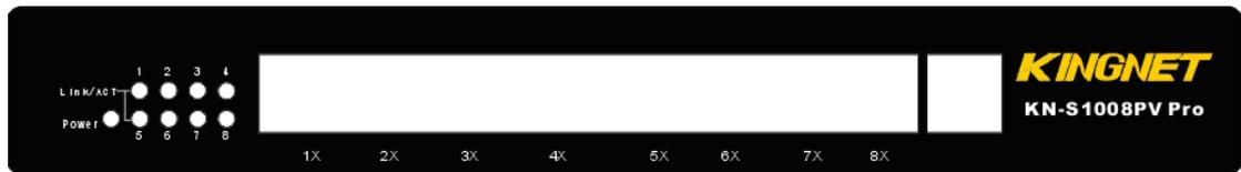
图 3-2 KN-S1008PV PRO 交换机的前面板示意图
