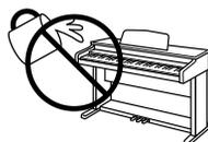
L'introduction d'eau, d'aiguilles ou d'épingles à cheveux, peut provoquer une panne ou un court-circuit. Ce produit doit être mis à l'abri des écoulements ou projections d'eau. Ne jamais placer sur le produit des objets contenant des liquides, tels que des vases ou autres récipients.
