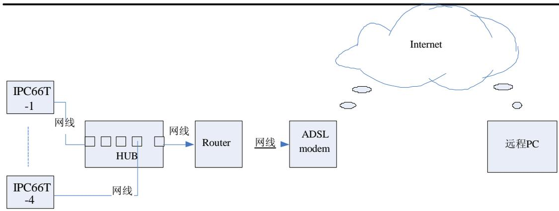
2)网络摄像机搭配 Router 应用框架
