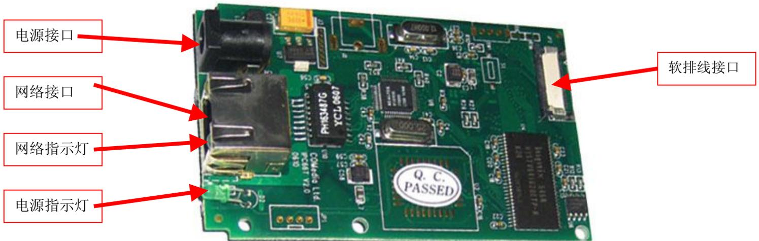
图1 硬件安装插孔及示意
