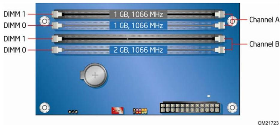
图 16. 使用三条 DIMM 下的双通道内存配置示例
