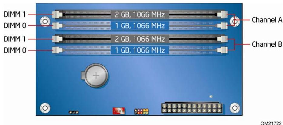
图 15. 使用四条 DIMM 下的双通道内存配置示例
