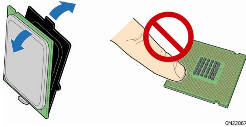
图 9. 从处理器保护罩中取出处理器
