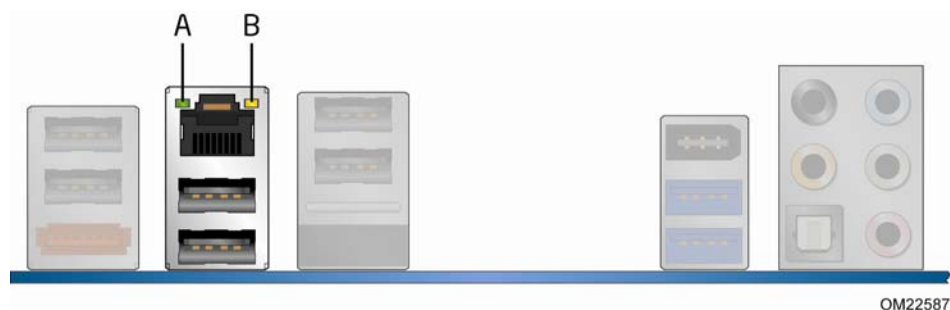
图 2. LAN 连接器 LED 指示灯
