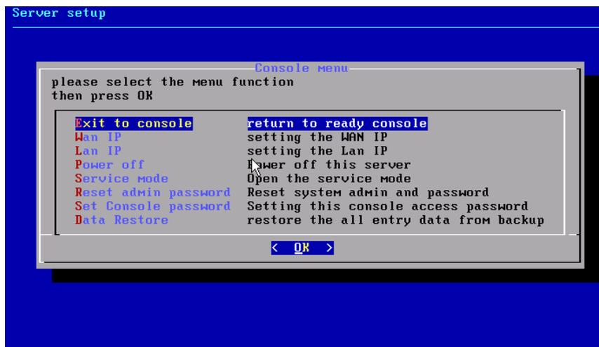
Wan IP：進入該選項可以進行 Wan 端網卡的 IP 設定，你可以選擇使用用 STATIC(固定 IP)，DHCP(由 DHCP 取得 IP)，或用 ADSL pppoe 撥接
