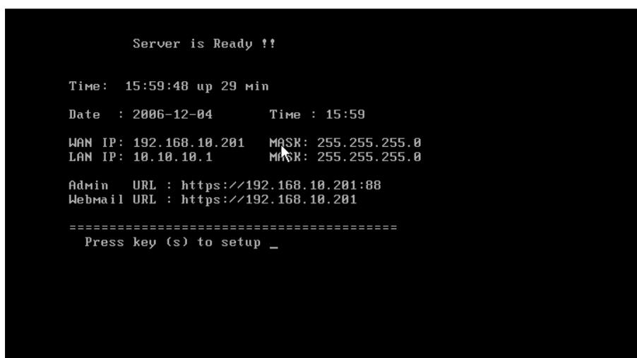
其中 WAN IP：表示對外連線所使用的 IP，系統至少需要有一個網路卡，來對外來連線，即使你將 InfoBOX 安裝於公司原有的 firewall 之後方，也必須設定在 WAN 端
