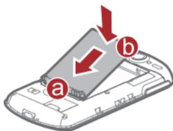
1. 将带有金色触点的一端插入电池槽底部，如图中 a 所示。
