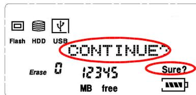
Step 7 – 如果確定要清除這個檔案或目錄，按下 ENTER 鍵執行清除動作，如(圖 2-56a)在裝置顯示區的 USB 框圖示會閃爍，直到訊息列顯示由” 0%”到” 100%”後會在顯示” ERASE OK”及右上角會顯示 complete 圖示。如果複製失敗如(圖 2-56b)訊息列顯示” ERASE ERROR”此時右上角則不顯示 complete 圖示。
