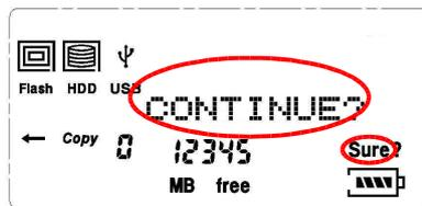
Step 9 – 如果確定要複製這個檔案或目錄，按下 ENTER 鍵執行複製動作，如(圖 2-70a)在裝置顯示區的 FLASH 框及 HDD 框圖示交互閃爍，直到訊息列顯示由” 0%”到” 100%”後會在顯示” COPY OK”及右上角會顯示 complete 圖示。如果複製失敗如(圖 2-70b)在訊息列會顯示” COPY ERROR”此時右上角則不顯示 complete 圖示。
