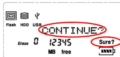
Step 7 – 如果確定要清除這個檔案，按下 ENTER 鍵執行清除動作，如(圖 2-42a)在裝置顯示區的 FLASH 框圖示會閃爍，直到訊息列顯示由” 0%”到” 100%”後會在顯示” ERASE OK”及右上角會顯示 complete 圖示。如果複製失敗如(圖 2-42b)訊息列顯示” ERASE ERROR”此時右上角則不顯示 complete 圖示。
