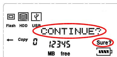
Step 6 –如果確定要複製所有資料，按下 ENTER 鍵執行複製動作，如(圖 2-18a)在裝置顯示區的 USB 框及 HDD 框圖示交互閃爍，直到訊息列顯示由” 0%”到” 100%”後訊息列會在顯示” COPY OK”及右上角顯示 complete 圖示。如果複製失敗如(圖 2-18b)在訊息列顯示” COPY ERROR”，此時右上角則不顯示 complete 圖示。
