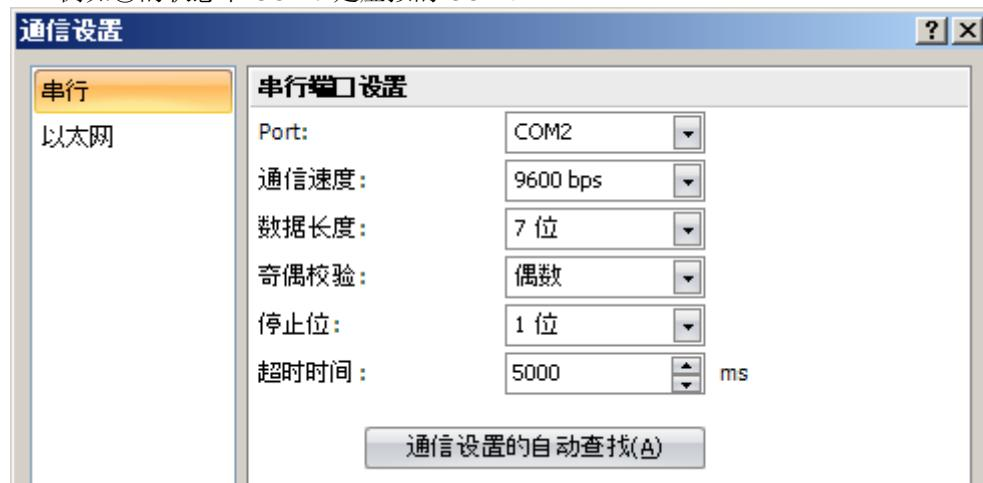
③ 指定 Pass-Through Tool 使用的实际 COM 端口编号。
