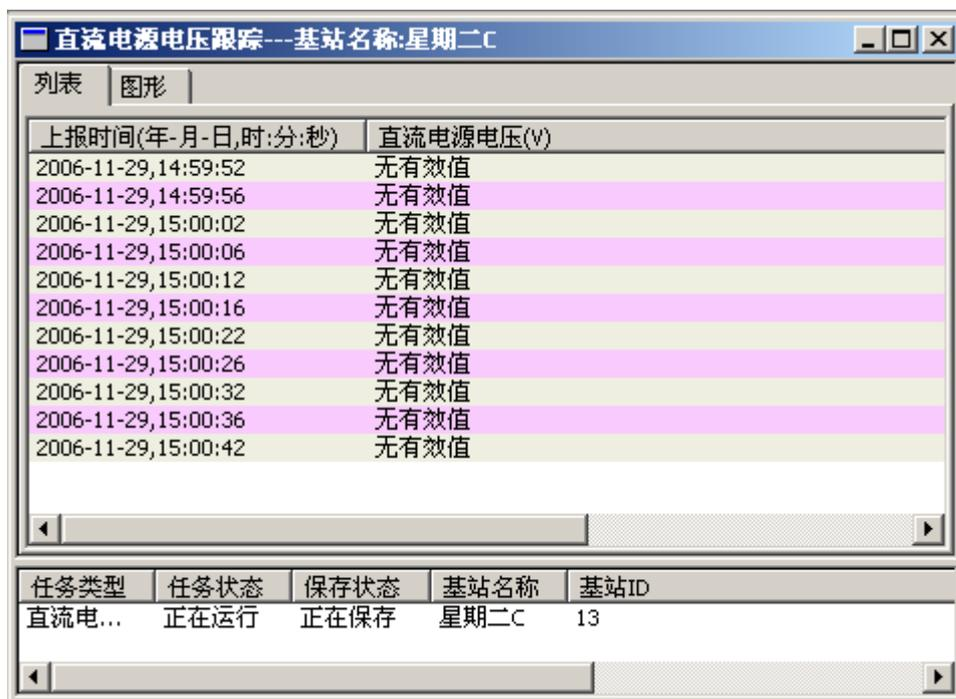
**步骤 5** 选择“图形”页签，可按图形化方式实时跟踪直流电源电压，如图 7-21 所示。
