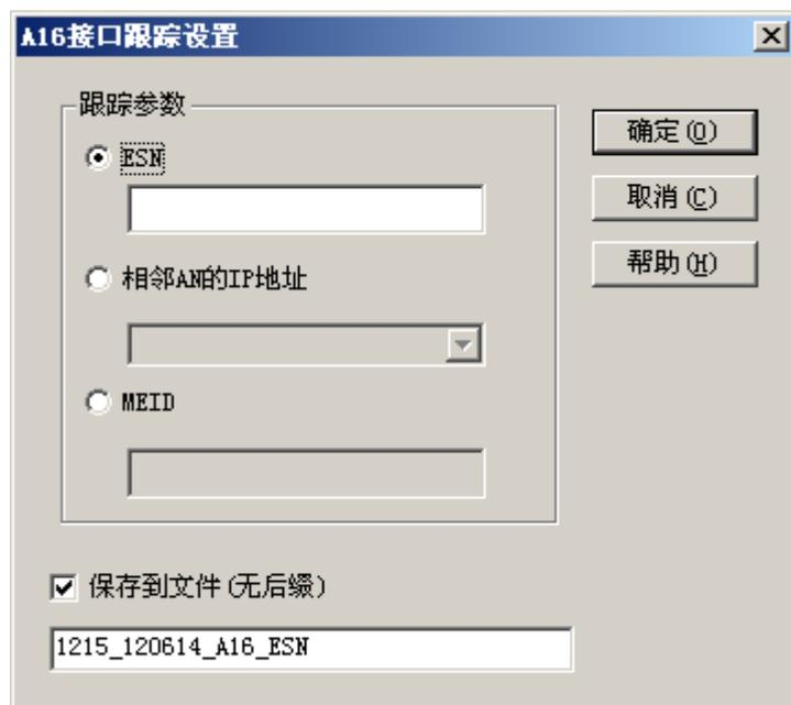
**步骤 2** 在对话框中输入被跟踪移动台的 ESN 号码、MEID 或对端 AN 的 IP 地址，单击“确定”按钮。
