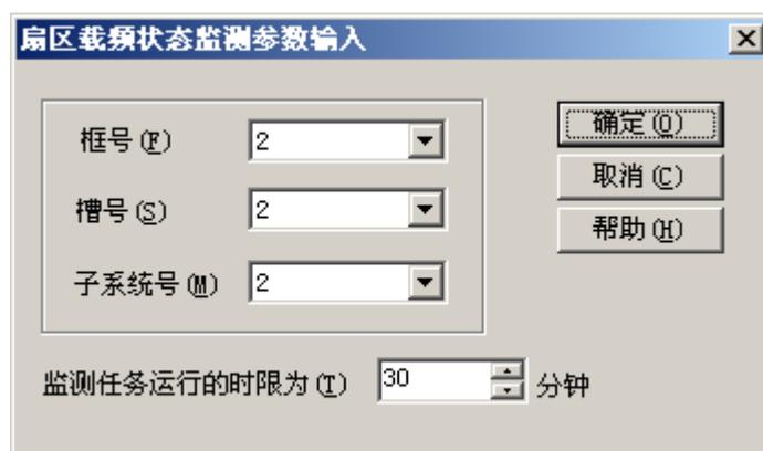
**步骤 3** 在“扇区载频状态监测参数输入”对话框中，选择“框号”、“槽号”、“子系统号”和“监测任务运行的时限”。
