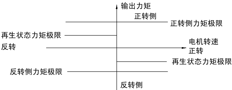
图 7.16 由模拟量输入的力矩极限
