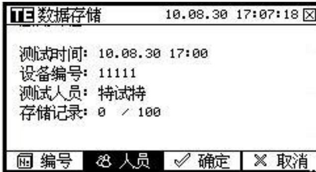
菜单解释：按“编号”功能按键，进入“输入法”界面，在输入法界面，可输入试品编号；
