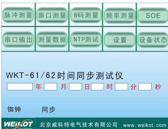
“铷钟”字样在闪烁，表示铷钟正在预热状态，开机预热时间约 15 分钟左右，铷钟锁定，“铷钟”字样停止闪烁。
