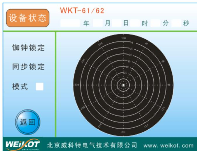
实时显示铷钟状态、GPS 状态、串口时间数据输出模式和卫星星图。
