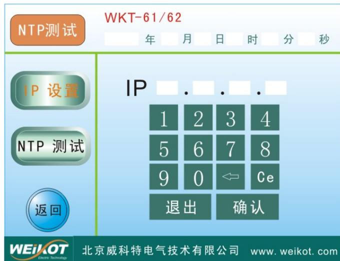
系统默认 IP 地址设置，按数字键进行 IP 地址设置，按“确认”键系统将自动跳到 NTP 测试界面。
