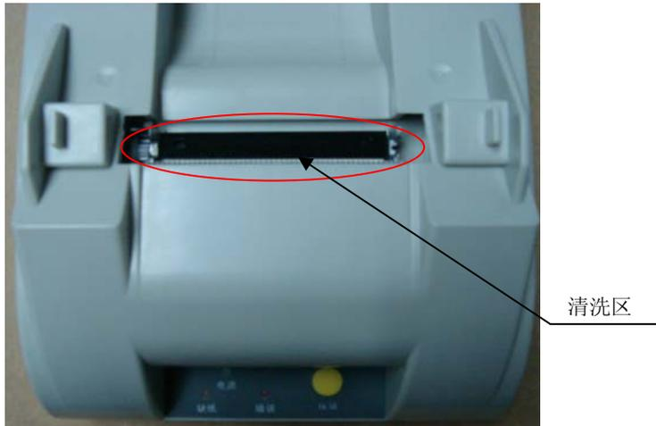
图2-5 打印头清洗区
