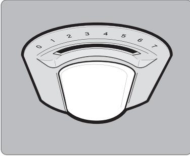
您可以根据需要调节位于冷藏室顶部的温控器旋钮的位置,对箱内温度进行调节。温控器将根据用户所调定的档位自动控制箱内温度在一定范围内。
