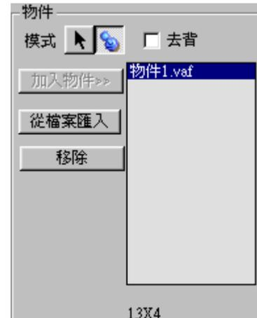
物件可以让你重覆的利用你所完成的圖案，在物件工具有兩種模式可以選擇，一個是選取模式，另一個是貼上模式，當你選擇**選取模式**的時候，你的滑鼠可以再畫步上選擇範圍也就是選擇想要當成物件的圖案，按下"加入物件>>"後就會把你選擇的圖案加到物件清單裡面，在此同時會把它存成一個單頁畫格式的檔案，除了用選取模式來加入物件到物件清單外，還可以從檔案來匯入物件，只要按下"從檔案匯入"鈕就可以選擇已經儲存好的單頁畫將它加入物件清單，選擇**貼上模式**的時候，只要點選物件清單中的一個物件，再將滑鼠移到畫布上，就可以把物件重現於畫布上，左圖最下面有一個"13X4"代表的就是物件大小的"寬X高"，物件工具就有點像是進階版的複製貼上功能。
