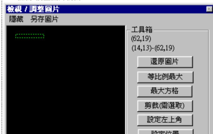
當你在方塊圖編輯器的圖片工具載入圖片後，或是按下檢視/調整圖片的時候就會出現這個檢視/調整圖片視窗，因為我們載入的圖片不一定他的位置以及大小就是適合我們想要的，所以在此可以讓我們做調整，調整的方式可以從工具箱提供的功能來進行，也可以從下面的手動修改來修改，首先從工具箱的內容介紹起，**還原圖片**的功能就像是他字面上所說的一樣，可以把圖片還原到最初載入圖片時的樣子，當你調整失敗的時候就可以把他還原重做，**等比例最大**的功能則是在不超過畫布大小的情況下將圖片放大大最大，**最大方格**的意思就是可以把原本圖檔的最小單位(像素)放大到跟方塊圖的一個方塊大小相同，在這個情況下所轉換出來的方塊圖會最接近原本的圖案，**剪裁**這個功能可以只
