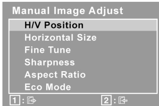
**H./V. Position** (水平 / 垂直位置) 将屏幕图像左右移动或上下移动。
