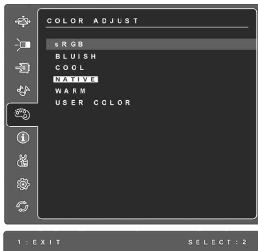
**sRGB-** 是一种颜色管理的工业标准，它支持很多最新的应用程序。启用此设置，LCD 可以更精确地显示原始色彩。启用 sRGB 设置后将关闭 Contrast(对比度) 和 Brightness(亮度) 调整。
