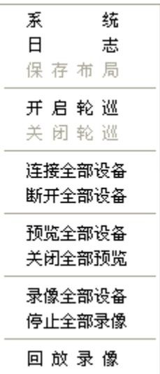
系统：主要为本地设置，如图片及录像的储存路径，录像打包长度，视频轮训时间等的设置。如下图所示：
