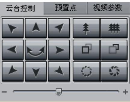
云台控制：可控制云台和镜头。
