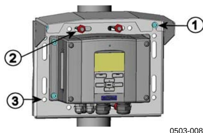
Figur 12 Montering av montagesats med regnskydd
