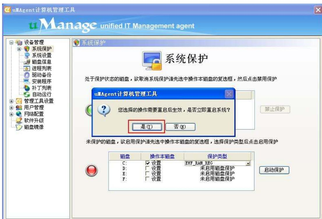
在启动保护之后，双击系统保护产生树形分支结构 EWF 保护并选中，会产生 EWF 保护的操作系统界面，当我们在对系统盘的内容做修改时，我们要点击保存数据，才能将修改真正写到磁盘里，根据提示重启计算机后生效。若在保存数据之后，没有重启计算机那么保护系统会把这个更改的数据做一个记忆。如果之后决定不保存数据，点击清除命令的选项就可以
