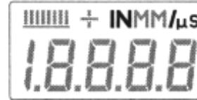
显示屏显示数值及不同的设置。通常显示最后一个测量值。此外，电池电量不足时，屏幕开始闪动，应该更换电池。
