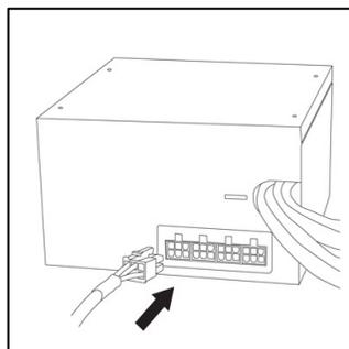
5. 電源ケーブルを電源側の AC 入力に接続してください。電源ケーブルは、TP-750 に同梱されている専用ケーブルを使用してください。すべてのデバイスを接続し、電源を入れる準備ができましたら、電源裏面のスイッチを「|」の位置にしてください。
