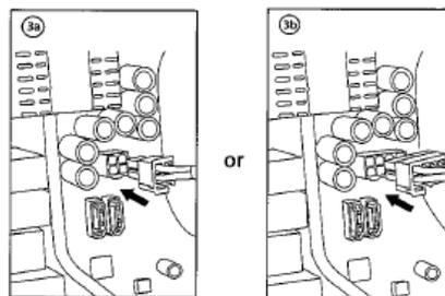
4. ケーブルパックから必要なケーブルを電源側のソケットに接続してください。PCI-E ケーブルを追加する際は、電源側の赤色のソケットに接続してください。それ以外の電源に同梱されているケーブルは、どのソケットに接続してもご利用いただけます。
