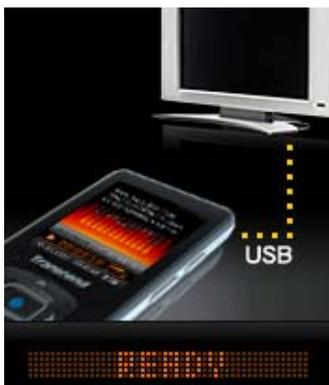
如果您使用 Windows® 系統，則「我的電腦」中會顯示一個新的卸除式磁碟圖示及代號，用來代表 MP850。
