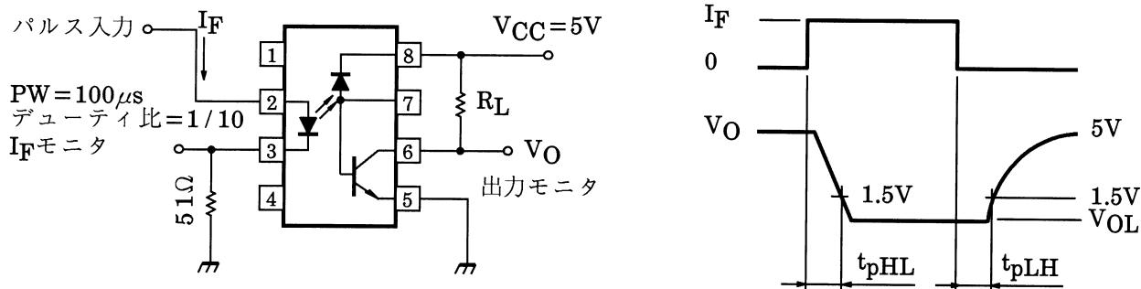
注 10: コモンモードノイズ除去電圧測定回路、波形
