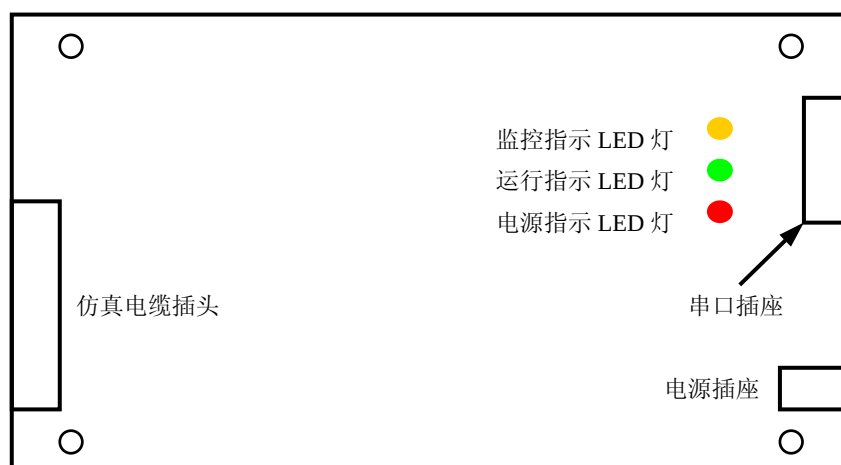
图 5.1 TKS-900 平面图（顶部俯视）
