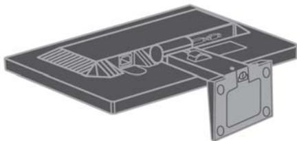
2. 将显示器正面朝下放在一个表面干净或柔软的布上，卸下支架上的螺钉。
