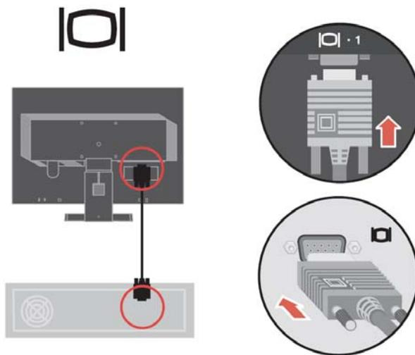
3. 将数据线连接到计算机背面的视频端口
