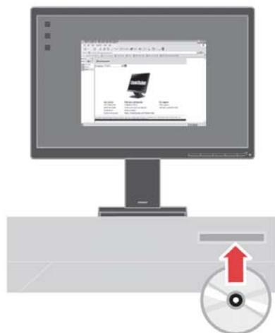
8. 如需优化设置显示器图像，按"自动图像设置"键。自动图像设置功能要求显示器的预热时间至少为15分钟。使用DVI线可不必满足上述预热要求。
