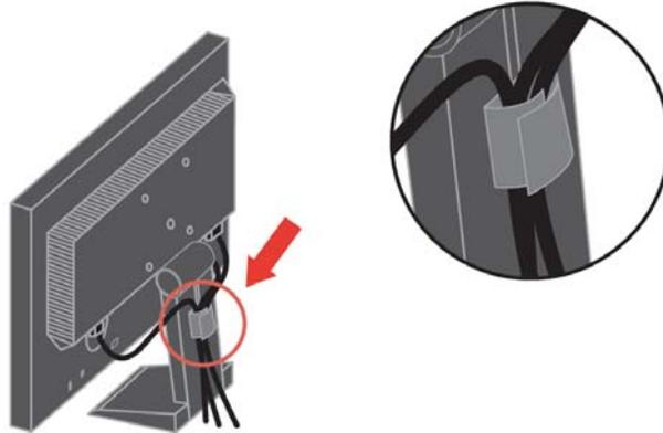
5. 将显示器电源电缆和计算机电缆插入接地的电源插座 **注意：** 该设备必须使用通过认证的电源电缆 应考虑相关的国家安装及/或设备规章。应使用通过认证的电源电缆，且根据IEC 60227（标号 H05VV-F 3G 0.75mm<sup>2</sup>或者H05VVH2-F2 3G0.75mm<sup>2</sup>）规定，电缆重量不得低于普通的聚氯乙烯柔性电缆。也可选用符合IEC 60245（标号 H05RR-F 3G 0.75mm<sup>2</sup>）规定的合成橡胶柔性电缆。
