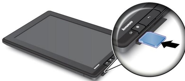
闪存介质卡插入 3 合 1 多媒体读卡器后，将显示一条弹出消息，询问是否要显示卡上的内容。要显示这些内容，请触摸**启动实用程序**。否则，请触摸**不启动**。
