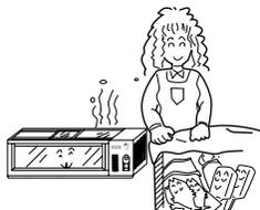
将柜内排水塞拔出，再将柜体后侧的放水管向外抽出约20-30mm，然后旋转180°，使管上的箭头朝下为“▼”，并在放水管下放一盛水容器，柜内的积水即可排出，并排入该容器内。
