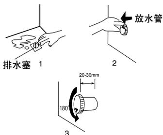
柜内积水排出后，用干布将冷柜擦干，堵上排水塞，放水管推进旋转，使小箭头向上“▲”，然后接通电源，待通电一小时后放入食品。
