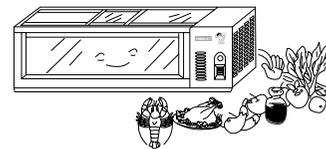
微冻保鲜时注意温控器的位置是否正确，并在柜内“微冻线”以下存入食品；冷藏时注意温控器的位置是否正确，并在柜内“冷藏线”以下存入食品。柜内不可放入食品过多，且不得超过负载线。
