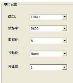
图4-19 P.T.Z 串行端口设置
