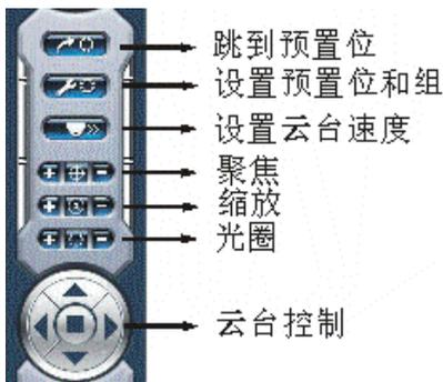
图5-2 P.T.Z 控制功能按钮面板
