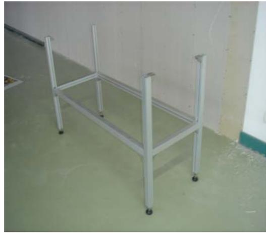
(2) 用内六角螺丝（下图 3）以及固定三角块将支撑架的上半部分装好。
