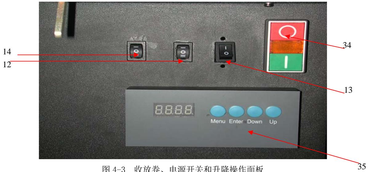
图 4-3 收放卷、电源开关和升降操作面板
