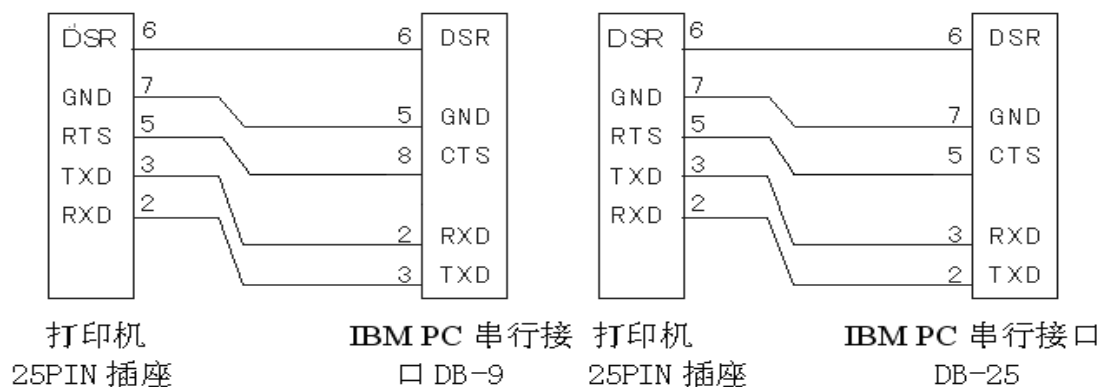
图 3-17 DB25 孔型串行接口与 PC 机串行口连接示意图
