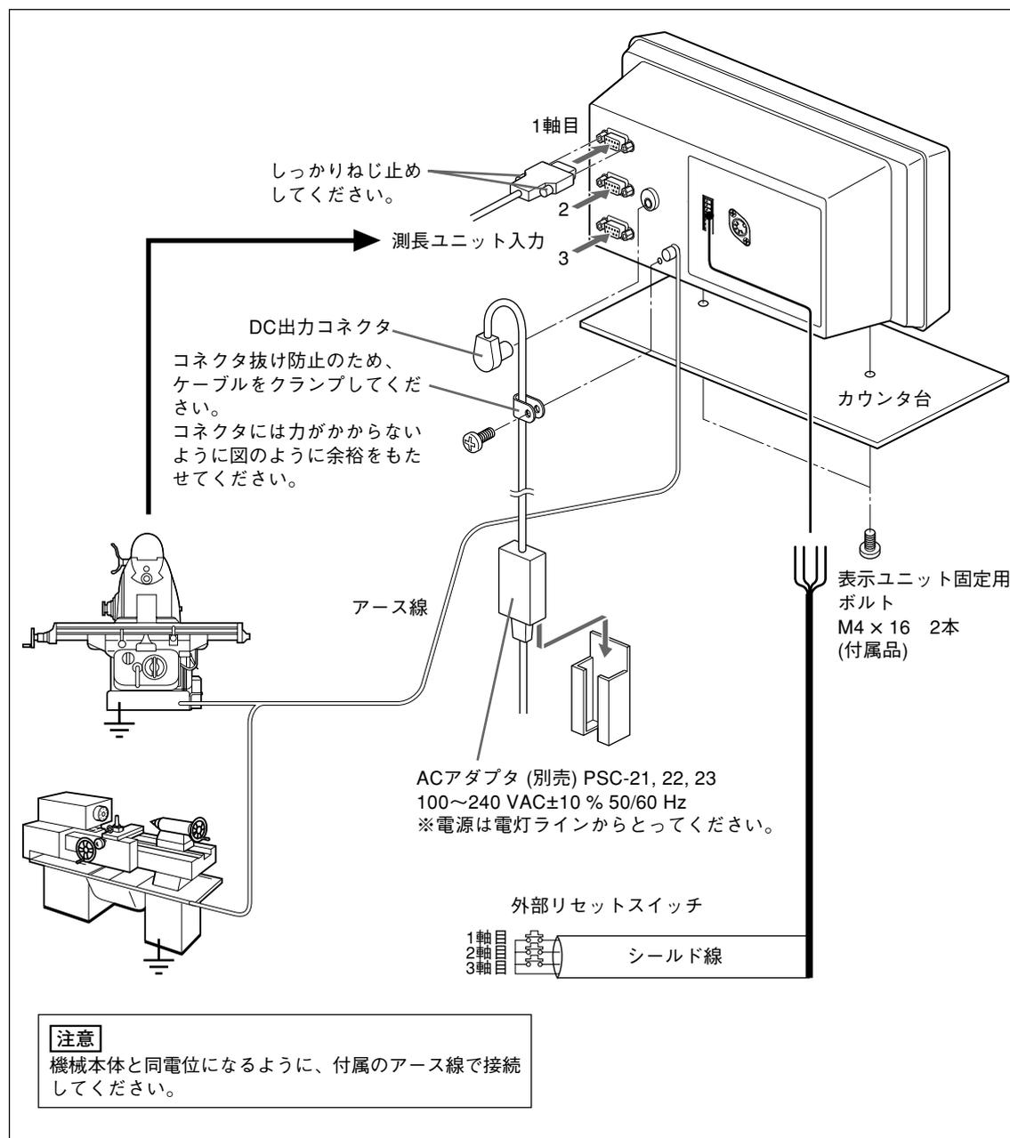
旋盤仕様で加算機能を使用する場合の接続
