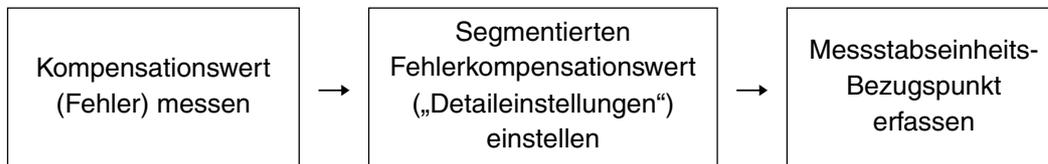
Wenn der segmentierte Fehlerkompensationswert eingestellt wird, schaltet das Gerät nach dem Abschluss der Detaileinstellungen, dem Einschalten der Stromversorgung oder der Rückstellung eines Fehlers automatisch auf den Messstabseinheits-Bezugspunkterfassungsmodus um. (Siehe Abschnitt 7-2-9 „Messstabseinheits-Bezugspunktmodus (Verwendung des Messstabseinheits-Bezugspunkts)“.)
