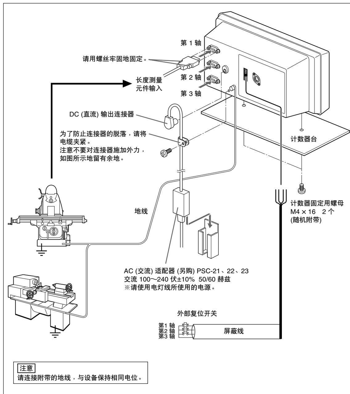
在车床功能使用加法功能时的连接
