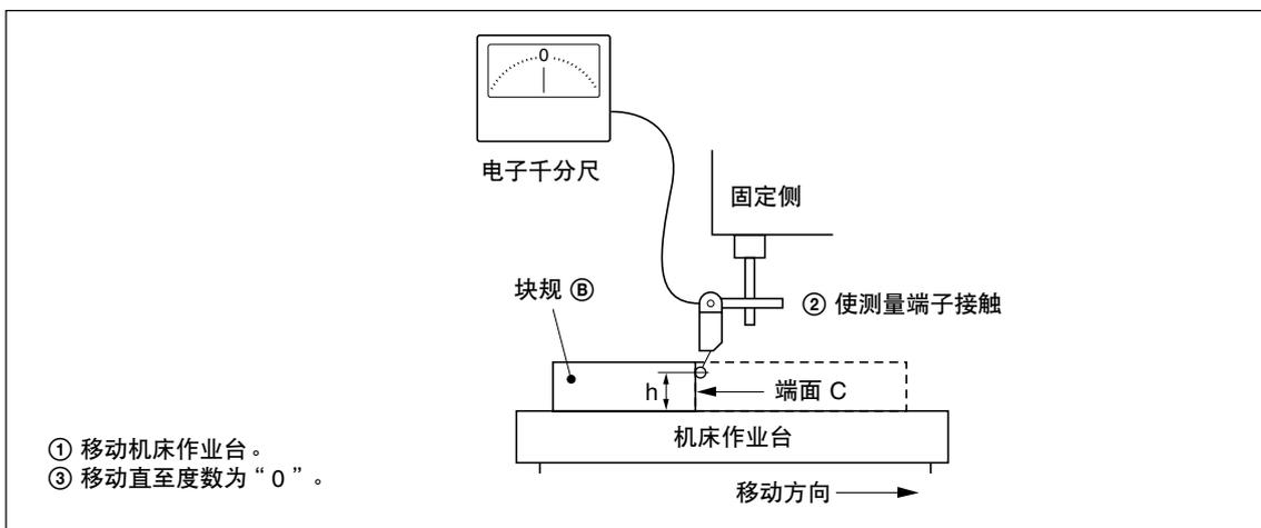
注) 到测量结束为止，不要改变测量端子的高度 h。
