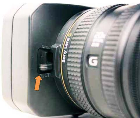
3. 如何卸除遮光罩：如下圖按下遮光罩的後方按鈕，並按照箭頭指示旋轉，即可卸除遮光罩；反方向轉入即可嵌回遮光罩。
