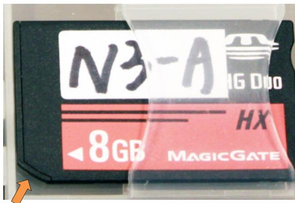
C. 確定記憶卡缺角的方向，正確的將記憶卡放入插槽。
