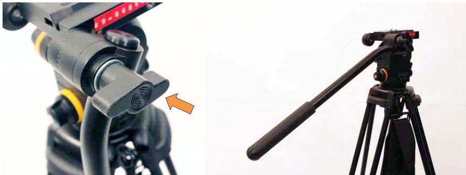
5. 調整水平：鬆開腳架中間水平調整旋鈕，將水平儀中的氣泡調整至圓圈內，再將水平調整旋鈕鎖好。
