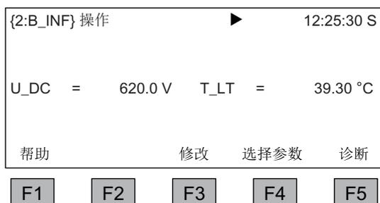
图 4-8 操作屏幕 - 示例：通过基本整流柜馈电
