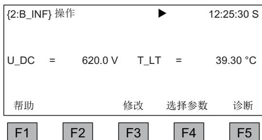
图 4-3 操作屏幕 - 示例：通过基本整流柜馈电
