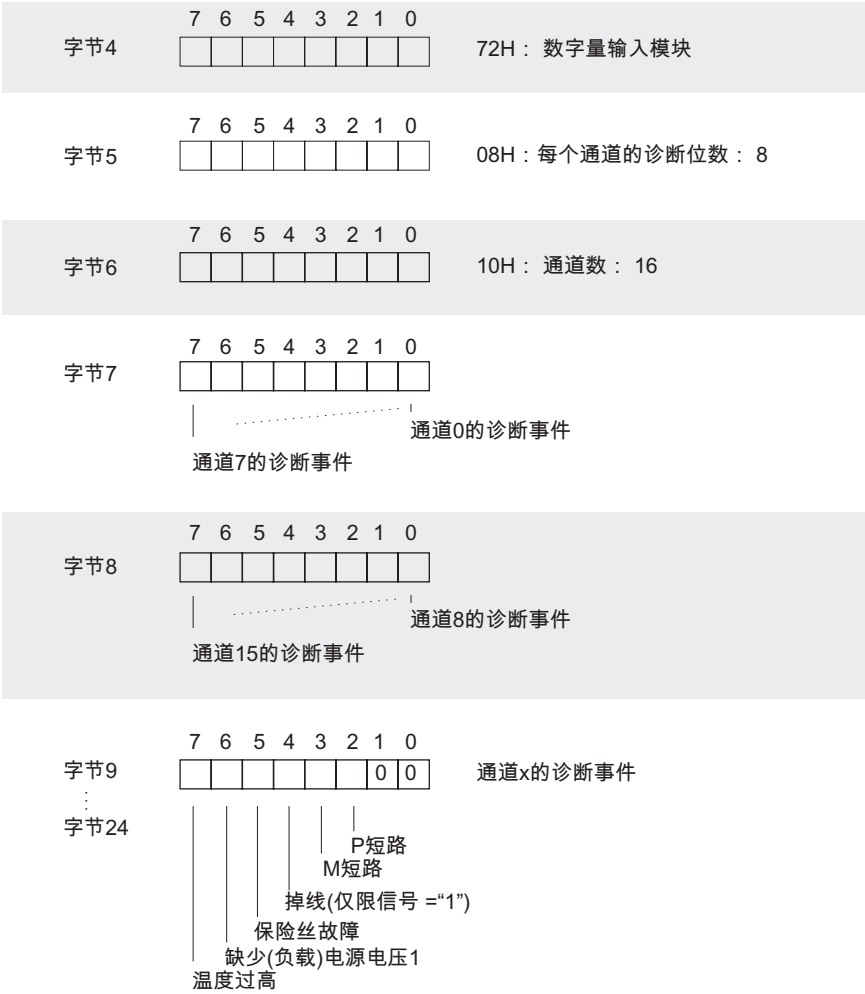
图 5-4 数字输出模块的诊断数据记录 1 ( 自字节 4 开始 )
