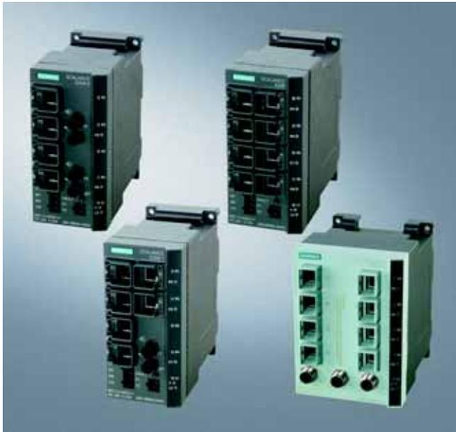
使用 SCALANCE X-200 系列通用型工业以太网交换机，能够经济地实现总线、星形或环形拓扑结构的工业以太网，满足网络的高可用性要求以及远程在线诊断功能。该交换机的防护等级为 IP30，可用于开关柜中。SCALANCE X208PRO 的防护等级为 IP65，可安装在控制柜外。
