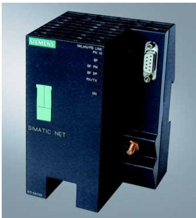
IWLAN 链接器 PN IO 支持采用 RCoax 和 WLAN 天线的 IWLAN 用于单轨小车输送机或立体仓库中的无线或非接触数据传输。借助于 PROFINET, 各种不同的 PROFIBUS 系统功能 (例如经由总线的诊断功能) 仍可使用。
