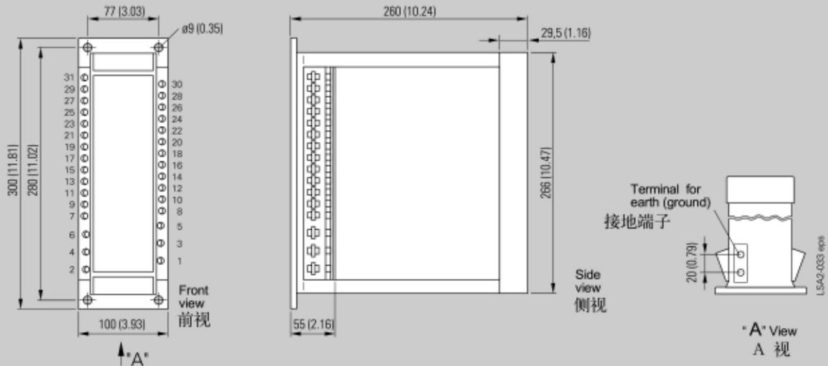
For flush mounting, terminals on the rear 用于嵌入式安装, 端子在后边。
