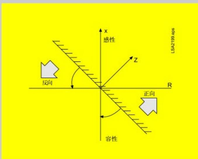
图22 方向时限过流保护的方向特性
