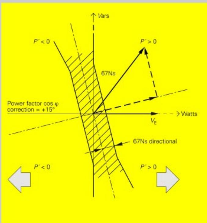
图23 对补偿网络用余弦测量的方法检测
