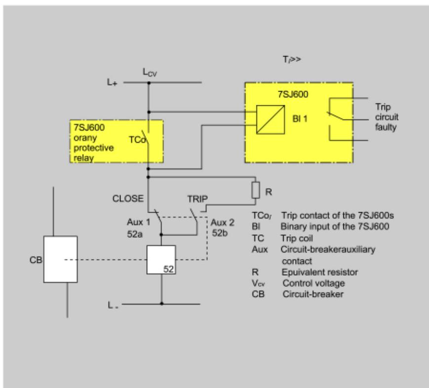
图25使用一个二进制输入的跳闸回路监视<sup>1)</sup>
