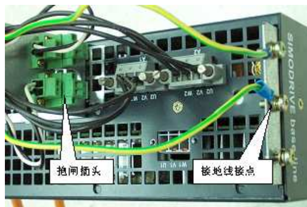
图2-13 抱闸插头在屏蔽板上的安装
