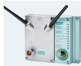
IM 154-6 PN HF IWLAN：ワイヤレスデータ伝送用インターフェースモジュール
