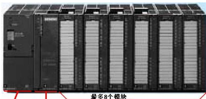
PS电源 IM153接口模块 通用的I/O CP FM模块
