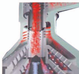
图3:蒸汽进入阀门
