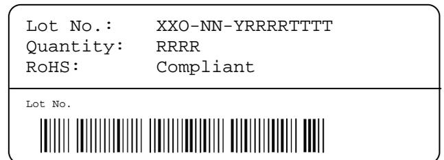
**图 15:** 卷轴上的标签: XX = 传感器型号 (21 for SHT21), O = 输出方式 (D = Digital, P = PWM, S = SDM), NN = 芯片版本, Y = 年的最后一位, RRRR = 卷轴上的传感器数量。TTTT = 追踪代码。
